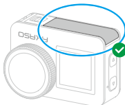
Крышка аккумуляторного отсека плотно закрыта
