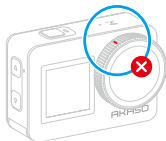
Крышка объектива неплотно закрыта
