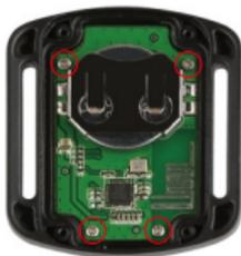
(3) 基板を持ち上げ、下記のように電池を引き抜きます。
