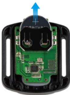
4. Installare la nuova batteria, mantenendo il polo "+" rivolto verso l'alto.
