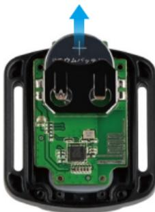
4. Instale la nueva batería, manteniendo el polo "+" hacia arriba.
