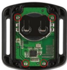
3. Levante la placa PCB y extraiga la batería, como se muestra en la imagen.
