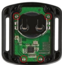
3. Heben Sie die Platine an und ziehen Sie den Akku heraus, wie in der Abbildung gezeigt.
