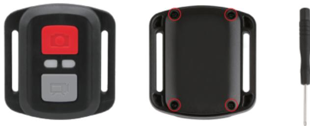
2. Retire outros 4 parafusos da placa de circuitos do controlo remoto.
