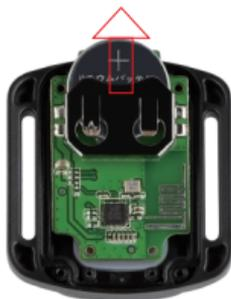
4. Instale a nova bateria, mantendo o pólo "+" virado para cima.
