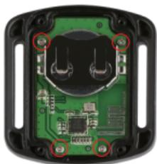
3. Levante a placa de circuitos e faça deslizar a bateria para fora, como indicado abaixo.
