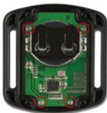
3. Heben Sie die Leiterplatte an und schieben Sie die Batterie heraus, wie unten dargestellt.
