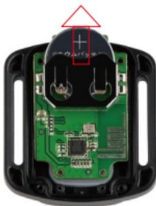
4. Installare la nuova batteria, mantenendo il polo "+" rivolto verso l'alto.
