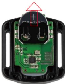
4. Installare la nuova batteria, mantenendo il polo positivo "+" verso l'alto.
