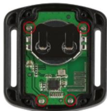
3. Levante la tarjeta PCB y deslice hacia afuera la batería, como se muestra en la imagen siguiente.
