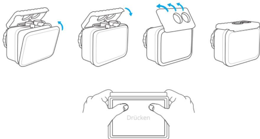
**Hinweis:** Drücken Sie und stellen Sie sicher, dass zwischen den wasserdichten Streifen des wasserdichten Gehäuses kein Spalt vorhanden ist.
