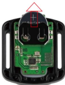
4. Setzen Sie die neue Batterie ein und achten Sie dabei darauf, dass der Pluspol nach oben zeigt.
